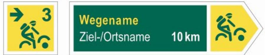
Im Wald werden bei der Kennzeichnung nur in Ausnahmefällen Wegweiser mit Ziel- und Entfernungsangaben zur Anwendung kommen. In der Regel sind Zwischenwegweiser mit Routennummern in größeren Abständen für die Orientierung ausreichend. Zusätzlich können Routennummern auf den Wegweisern dargestellt werden.
